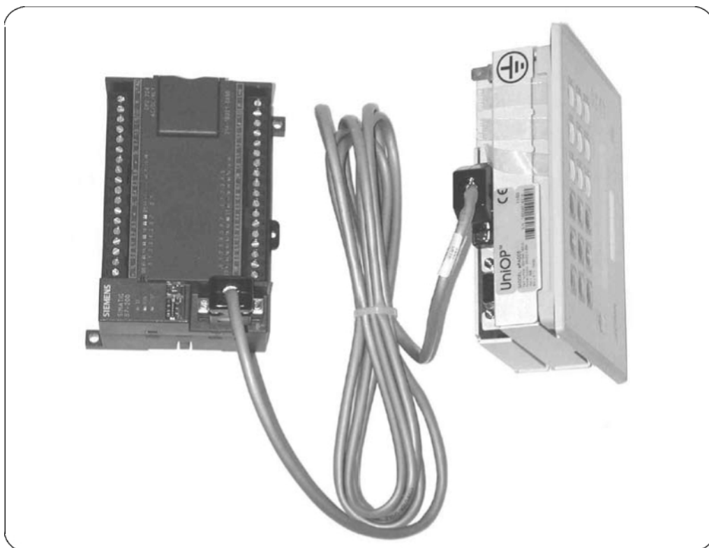
fig. 19: connessione dell'UniOP™ con il PLC
